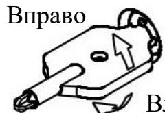
Регулировка ширины влево или вправо: от  $0^\circ$  до  $7^\circ$  ( $3,5^\circ$  один клик)
