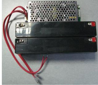
Аккумуляторная батарея бесперебойного питания обеспечивает работу автоматической двери в течение 2-х часов после отключения питания от сети 220 В.
