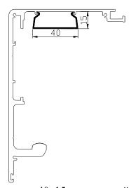
Все провода укладываются в кабель-канал 40х15 мм, который защёлкивается в специальный паз.
